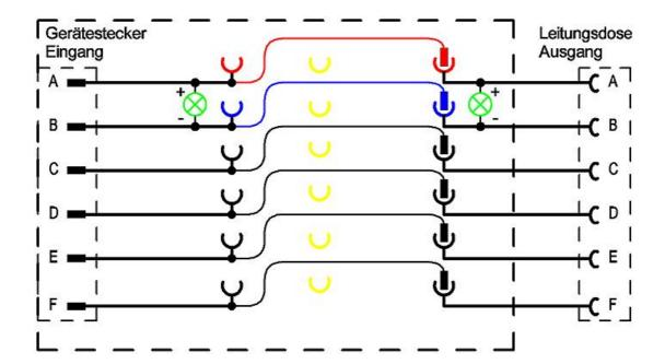
Die elektrischen Leitungsbrücken verbinden die Geräteeingangsseite direkt mit der gegenüberliegenden Ausgangsseite.
