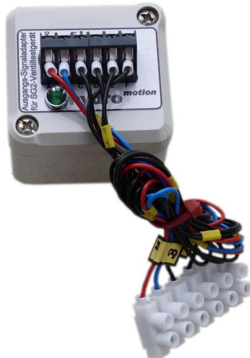
Die ausgangsseitigen Lüsterklemmen dienen zur Isolation der Signalleitungen.
